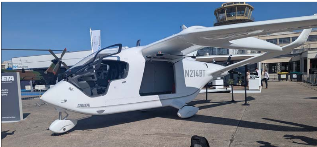
L'Hélic de Pivotal est le premier eVTOL au monde que vous pouvez acheter et piloter. Il vole aux États-Unis selon la règle FAA Part 103 sans que le pilote ait besoin de licence — dans d'autres pays, il pourrait être considéré comme un ULM.
