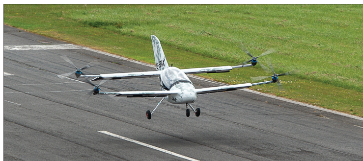
Selon Brooks, les atterrissages avec les moteurs désactivés sont faciles, l'avion a un coefficient de finesse de 9/1.
