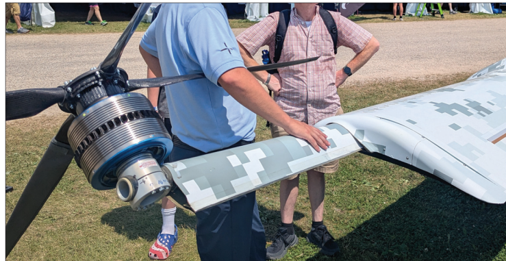
Les hélices, fixées sur des extensions d'ailes, ne provoquent pas de vortex et réduisent la traînée.
