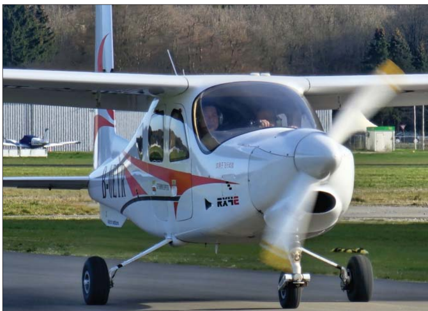
L'Académie de l'Aviation Générale du Liaoning RX4E—un avion électrique en fibre de carbone à quatre places—a été certifiée selon les règlements de la Part 23 en janvier 2025 par la CAAC chinoise.
