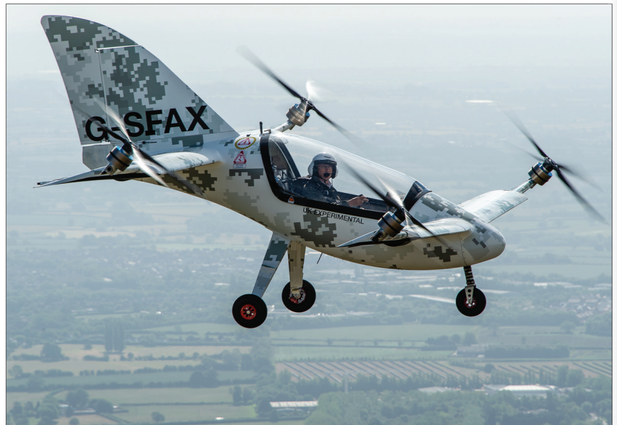
Un oiseau inhabituel sur l'Angleterre. Le grand gouvernail assure une bonne stabilité longitudinale malgré le fuselage court.
