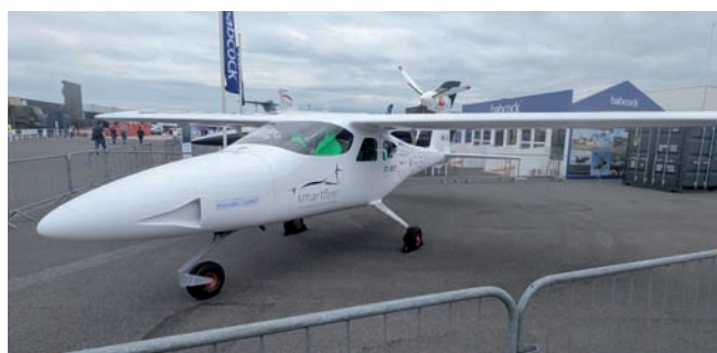
Le Smartflyer, originaire de Suisse, est équipé d'un générateur dans son long nez.
