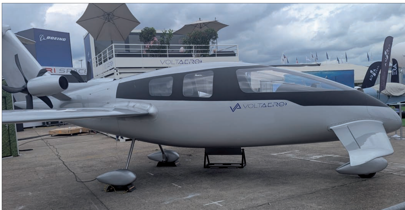
Le Cassio 330 de Voltaero a été présenté à Paris avec son nouveau moteur hybride en série et deux moteurs électriques dans des nacelles situées sur les côtés du fuselage.
