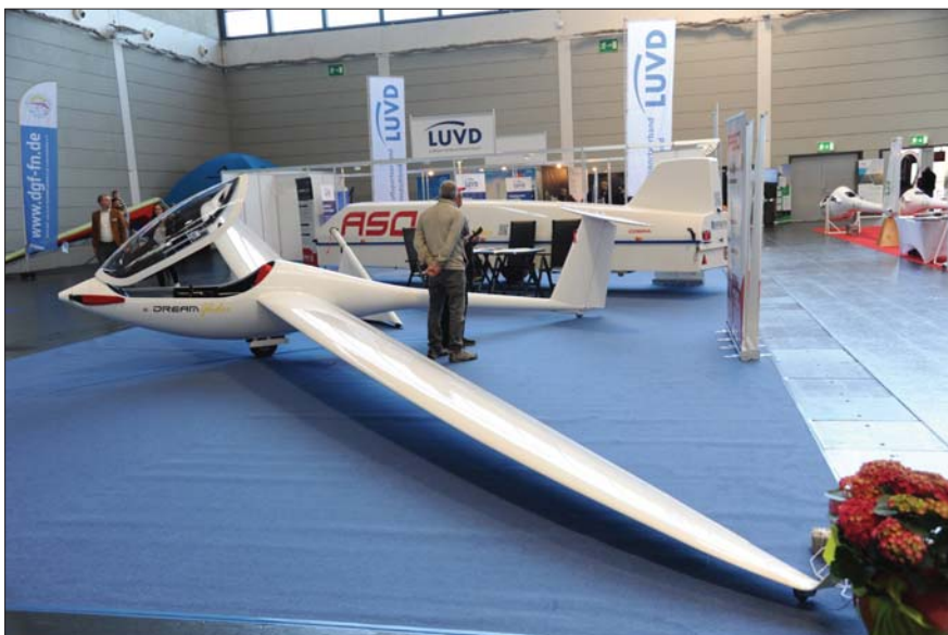
Il y a peu de nouvelles entrées dans le domaine des planeurs ultralégers, comme le DreamGlider monoplace d'ASO qui possède une hélice repliable dans le nez de l'appareil et est capable de décollage autonome.
