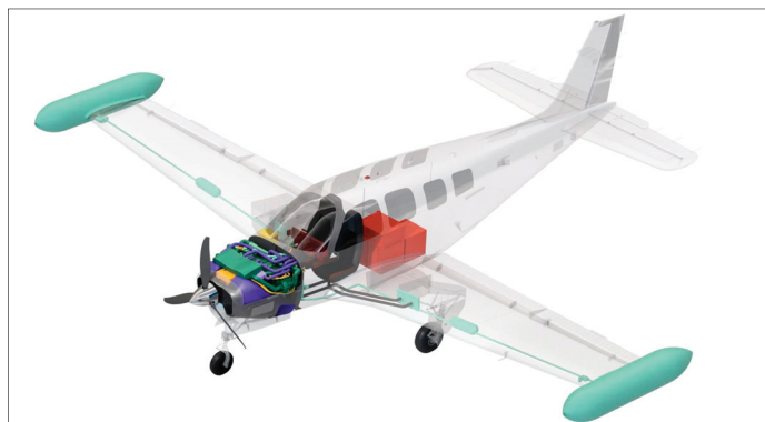
La société australienne Stralis convertit un Beechcraft Bonanza en avion électrique équipé de piles à combustible.
