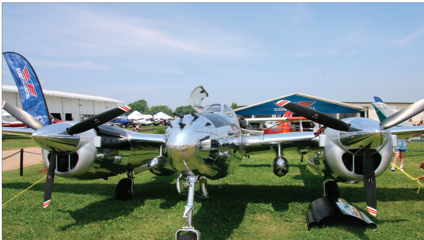
Cet avion de construction amateur, présenté sur stand Continental Aerospace Technologies, est un P-38 Lightning à l'échelle 2/3, il est équipé de deux Continental TIO-360.
