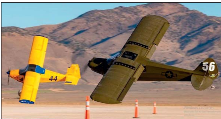
Un HIGHLANDER et un CARBON CUB KITPLANE, tous deux recouverts d'Oratex, ont des performances supérieures et une consommation inférieure à celles des avions original.
